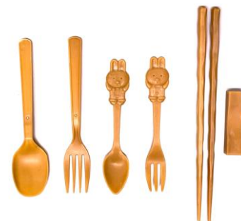
図 4. 米率 51%の米粉バイオマスプラスチック射出成型試作品
