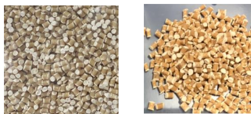
図3 開発した酒米米粉バイオプラスチック素材: インフレーション成型用ペレット(左)と射出成型用ペレット(右)
