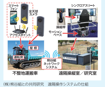
(株)熊谷組との共同研究 遠隔操作システムの仕組み
