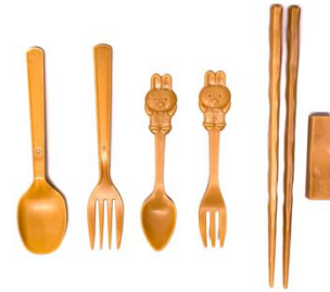
図 3. 開発した米率 51%バイオプラスチックの射出成形品
