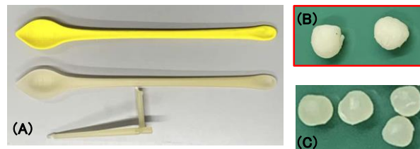
図 5. (A) ジャガイモデンプン・バイオプラスチックのスプーン (B) 酒米米粉バイオプラスチック 素材試作品 (C) ジャガイモデンプン・バイオプラスチック素材
