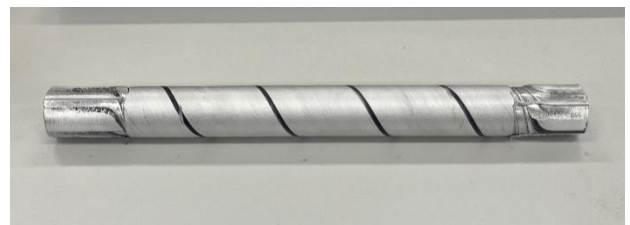
図 2 ねじり加工した工業用純アルミニウム A1070 丸棒
