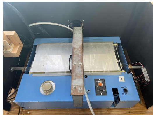
図 3 大気圧プラズマ装置の写真
