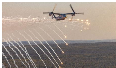
図1 フレアを使用している様子
