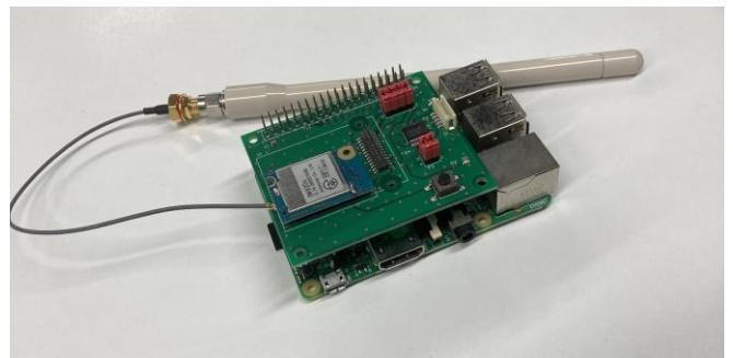
図4 Raspberry Pi を用いた無線モジュール(IM920s)
