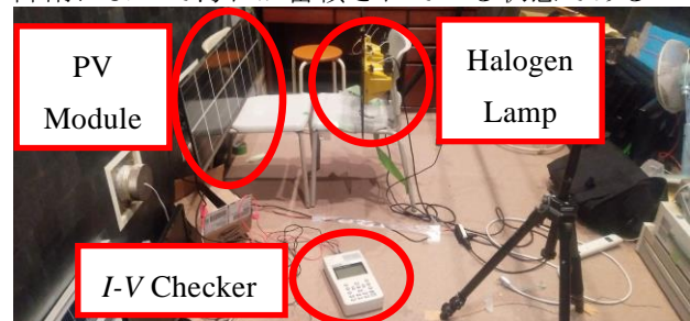
図 1 ハロゲン灯を使用した P - V 特性の測定
