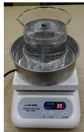
図 2 塩水浸漬試験装置
