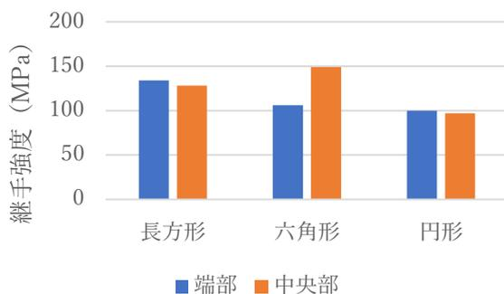
図3 継手予測強度と接合部品形状の関係
