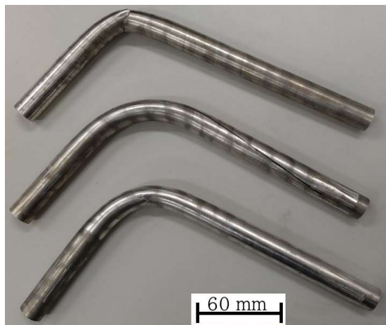
図 2 曲げ加工を施したパイプ 上：未ねじり，中：ねじり，下：ねじり戻し
