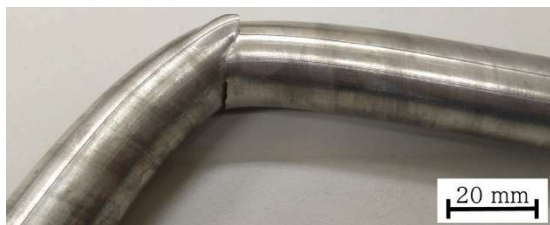
図 1 曲げ加工によるパイプの割れ
