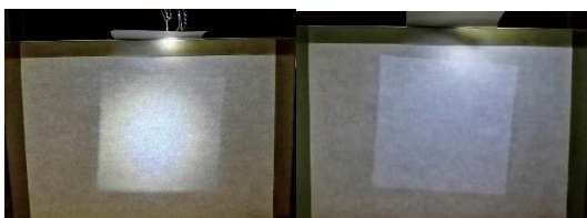
図 3 砲弾型 LED (左) と表面実装型 LED (右)
