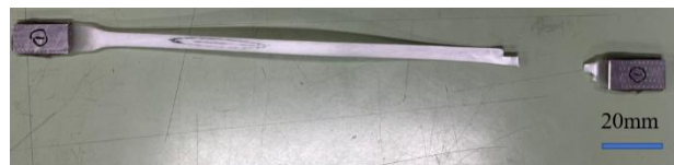
図3 加熱引張試験の代表例
