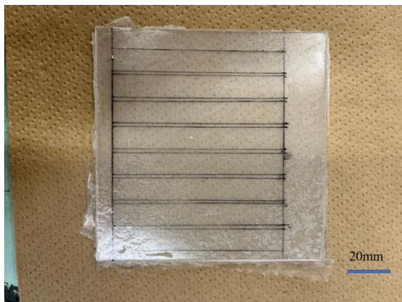
図1 PP板の外観写真
