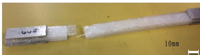
図4 破断した 200 mm/s [0/90]_{11} の試験片
