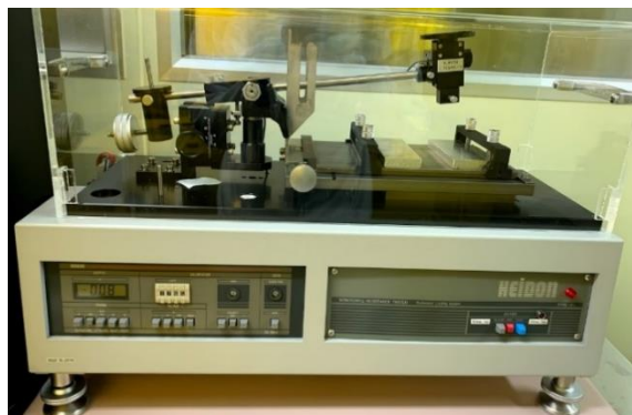
Fig.1 連続加重式引掻強度試験機
