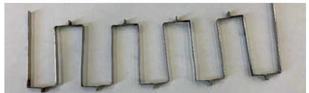
図1 作製した5対モジュール(素子長7cm)の写真
