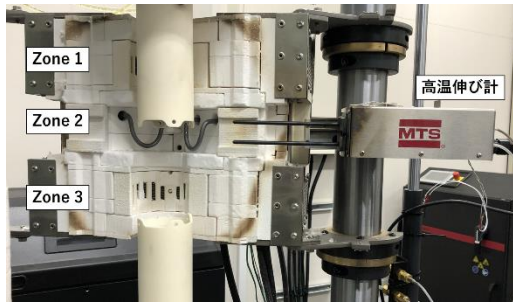
図1 力学試験装置の加熱炉と伸び計
