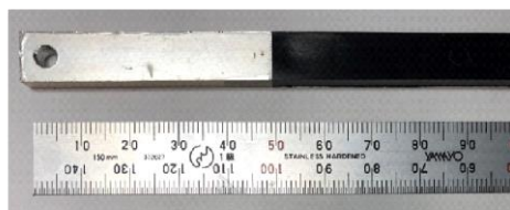
Fig. 1 樹脂/金属接合体試験片外観
