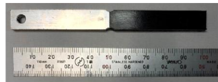
Fig. 2 樹脂/金属接合体自由縁加工後
