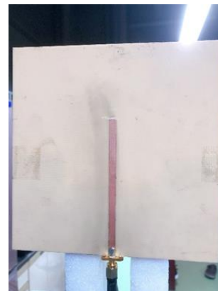
図 3 プリントモノポールアンテナ
