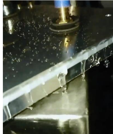
図4 水漏れの様子
