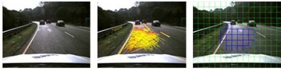
図 4 入力画像 図 5 線分検出 図 6 鏡面反射領域 (黄色線分) の検出結果
