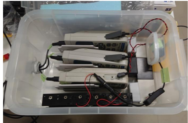
図2 塩濃度計の内部
