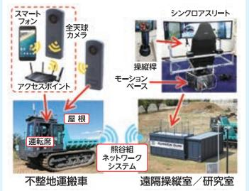
(株)熊谷組との共同研究 遠隔操作システムの仕組み
