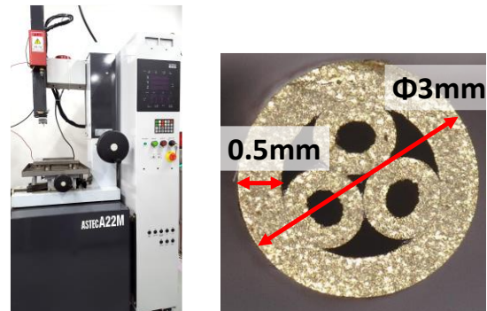
Fig.1 細穴放電加工機 (左) とパイプ電極断面 (右)
