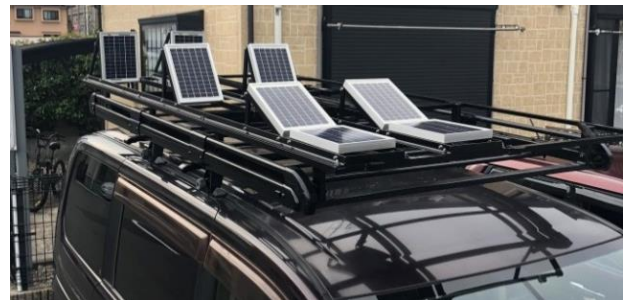
図1 車に搭載したPVモジュール
